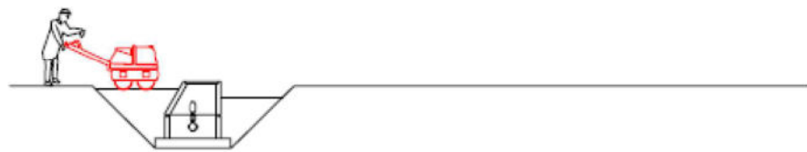
7. Compactació de terres al voltant del pou
