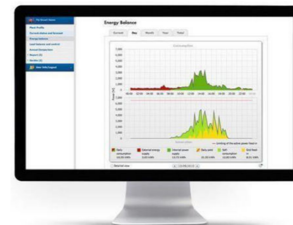
Figura 8: Software de monitorització de la planta fotovoltaica
